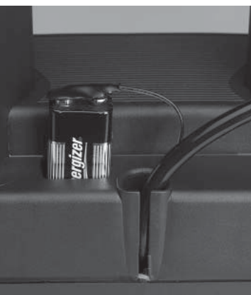
Pufferbatterie mit Kabel für Notabsenkung beim Okin-Antrieb
