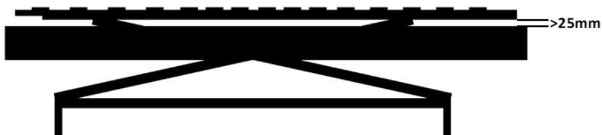
Slika 2: Če najmanjše razdalje med ogrodjem postelje in posteljnimi okvirjem ni mogoče ohraniti, se ležišče ne sme spustiti v posteljni okvir in se lahko spusti le toliko, da je med zgornjim robom posteljnega okvirja in spodnjim robom ogrodja vsaj 25 mm (= 2,5 cm).
